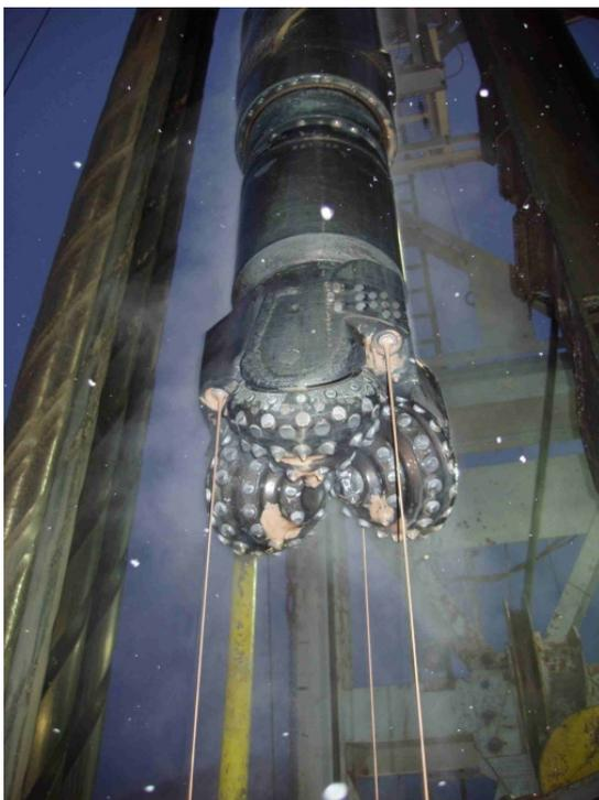
**Abb. 7** Kontrollausbau eines 12<sup>1</sup>/<sub>4</sub>" Insert-Bits und PDM-Motors (GeoWell GmbH)
