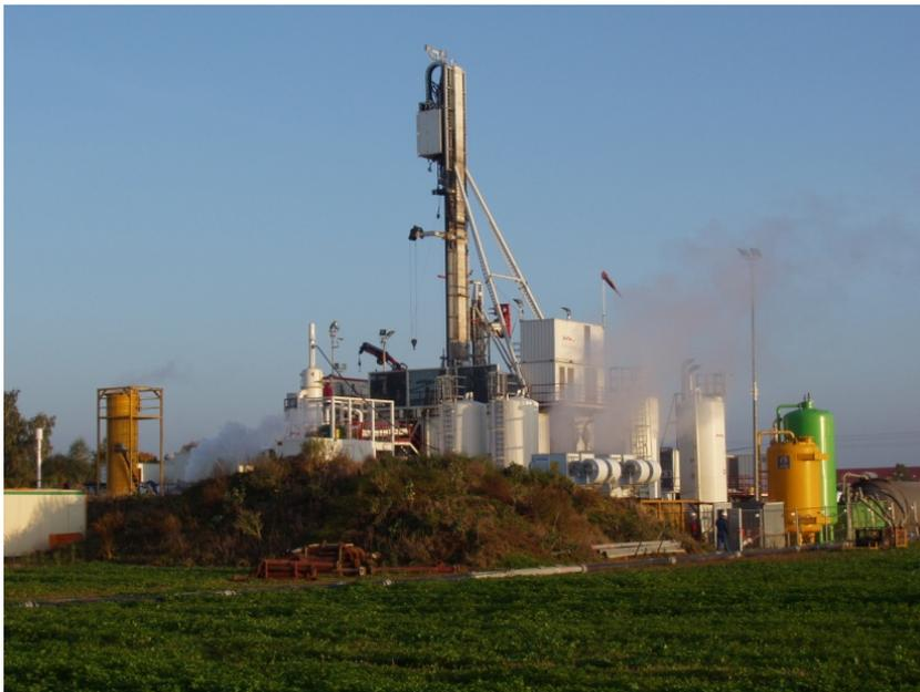
**Abb. 8** Kompaktbohranlage mit Fördertesteinrichtung (GeoWell GmbH)
