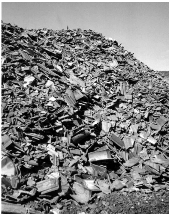
Abb. 6 > Dachziegelbruch – ausschliesslich Dachziegel.
