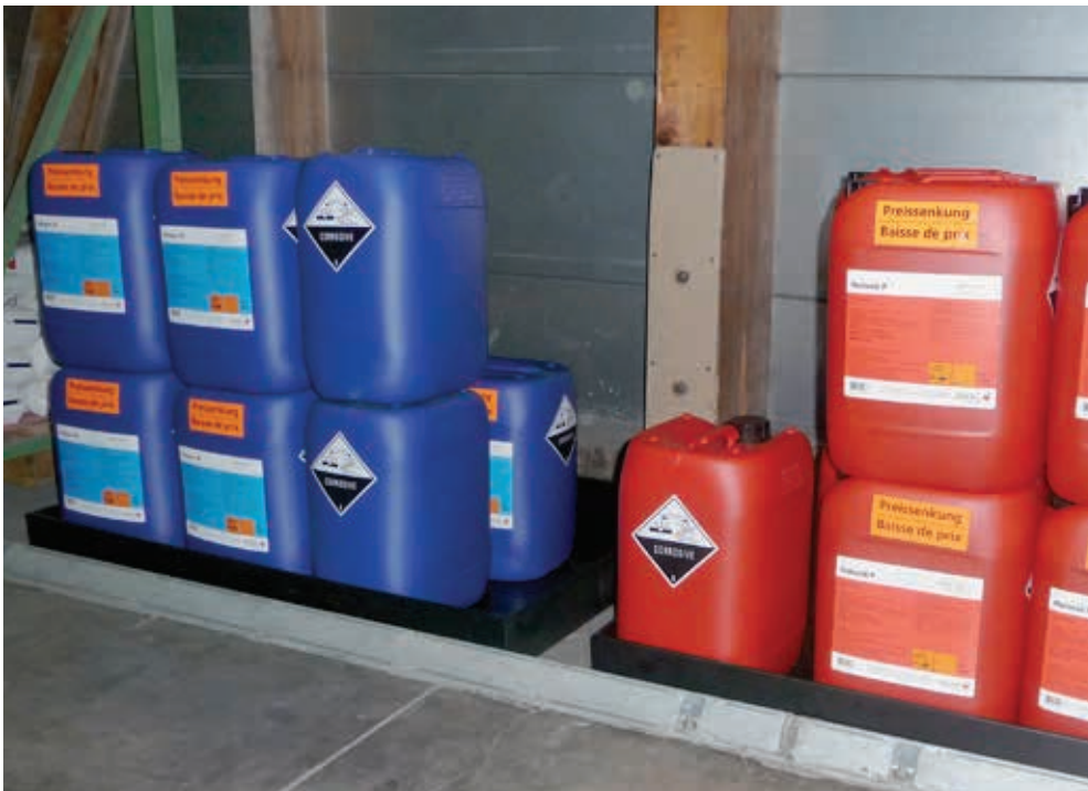
Bei Betonböden sind mindestens die Säuren in beständiger Auffangwanne zu lagern.
