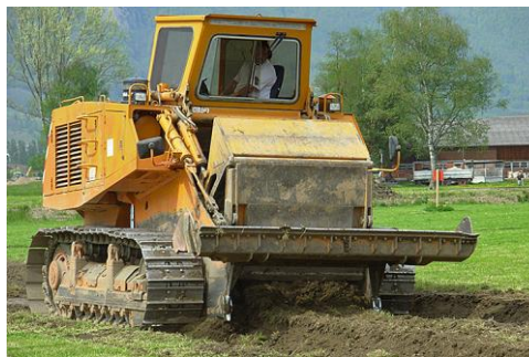
Abb. 30 > Bodenwiederherstellung mit Planierfraupe unter feuchten Bedingungen
