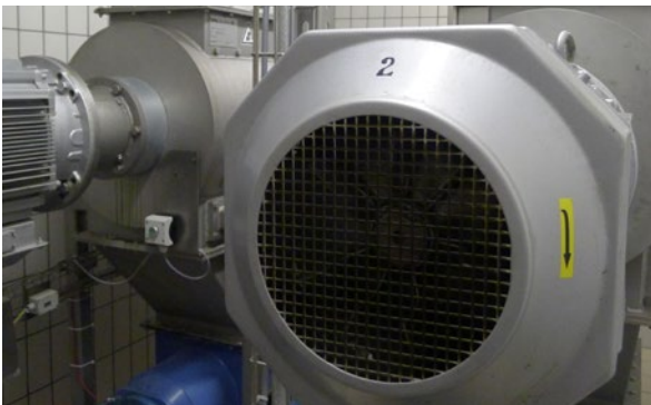
Abbildung 43: Über die Hammermühle werden Festabfälle zu flüssigem Abfall zerkleinert.
