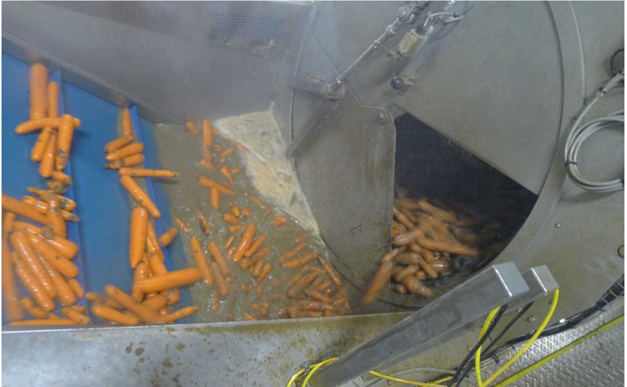
Abbildung 9: Rohprodukte (Karotten) werden in einer Drehtrommel im Wasserbad gerüstet. Der gegenseitige Abrieb erzeugt eine saubere und geglättete Oberfläche. Foto: tbfpartner
