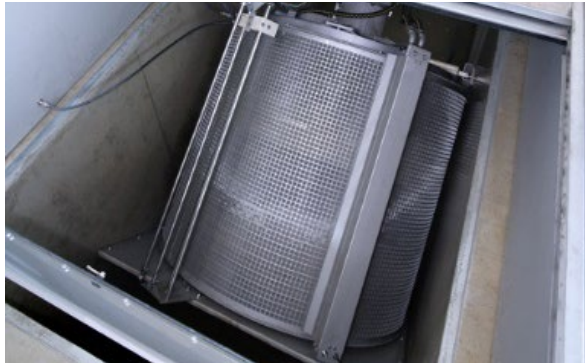
Abbildung 40: Siebtrommel zur Abscheidung von Feststoffen (Anlage Fa. Huber Picatech)
