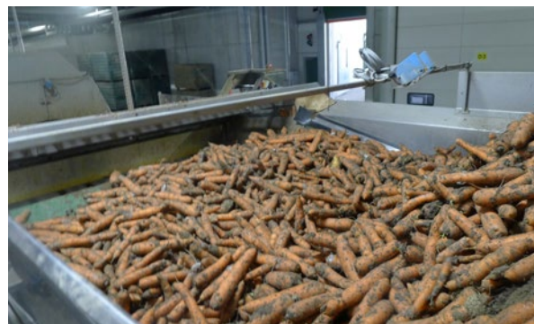
Abbildung 8: Auf dem Rüttelband werden die Karotten enterdet.
