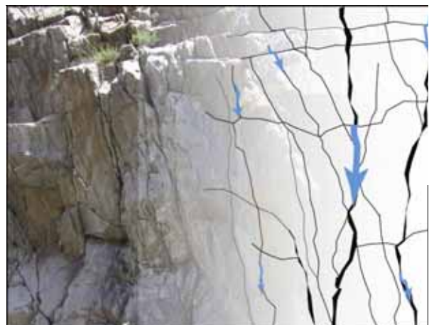
Abbildung 6d: Fließwege des Grundwassers im geklüfteten Gestein.
