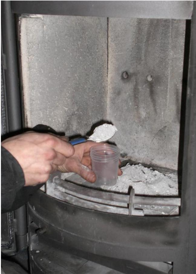
Entnahme einer Aschenprobe
