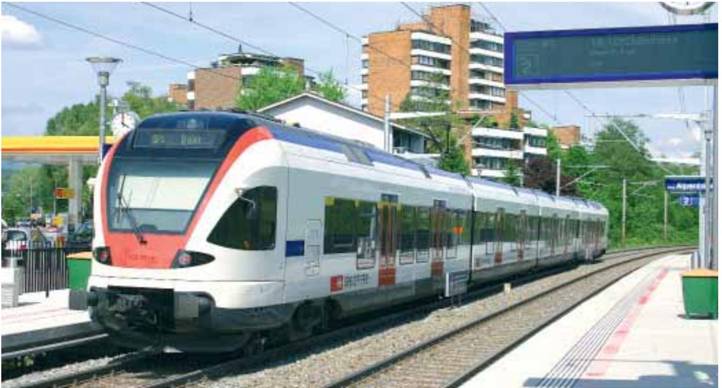
Der Kanton Zug hört auch bei der Stadtbahn Zug genau hin. Bei den Flirts sind lärmige Bauteile wie Kühlanlagen und Kompressoren schalldämmend und die Räder mit lärmarmen Scheibenbremsen ausgerüstet. So ist der Flirt mit 65 Dezibel (A) im Stillstand und mit 76 Dezibel (A) in Fahrt (mit 80 km/h in 7,5 Meter Distanz) deutlich leiser als konventionelles Rollmaterial (Grafik Seite 4).
