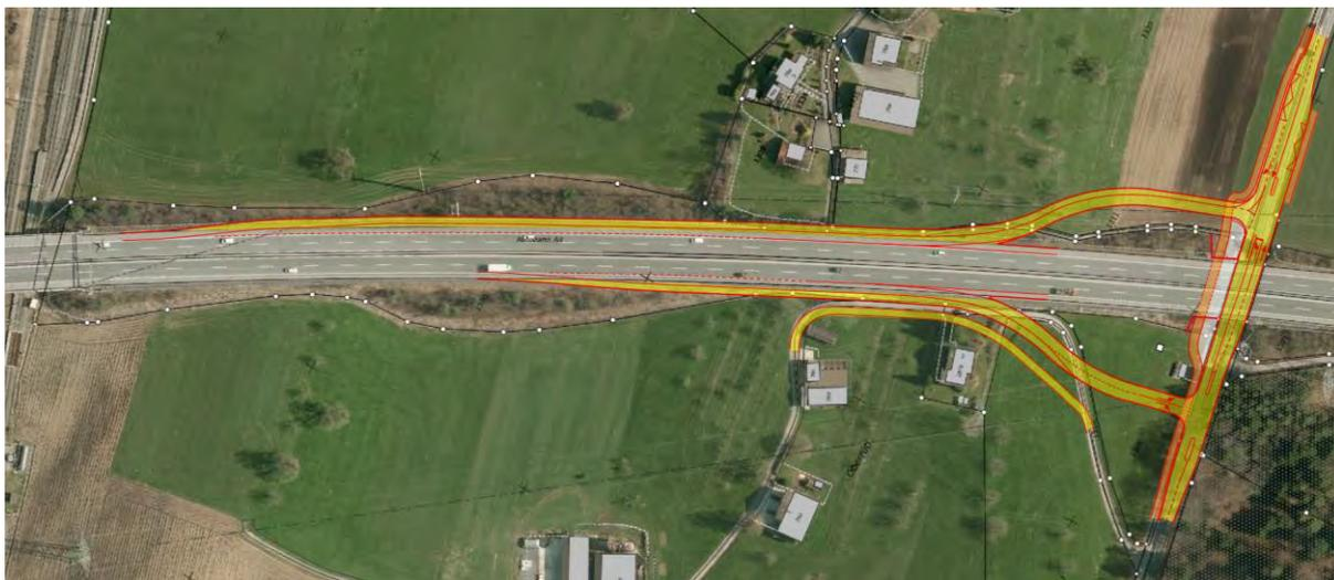
Am Kreisell Forren verbleibt lediglich ein Kapazitätsengpass von der Blegistrasse, welcher mit einem Bypass einfach gelöst werden kann. Der Bypass bildet nach dem Kreisell gleich die Rechtsabbiegespur zur Autobahn Richtung Süd. Auch dient der Bypass als Fortsetzung der geplanten Busspur gemäss AP 3 dem öffentlichen Verkehr Richtung Nordost (Hünenberg, Cham und Küssnacht).
