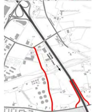
**R1+R2+A5 (R12A5)** Mit dieser Kombination werden sowohl der Autobahnanschluss Rotkreuz, wie auch die Chamerstrasse und der Forrenkreisel optimal entlastet. Durch die bessere Aufteilung des Verkehrs zwischen den beiden Autobahnanschlüssen ist auch der komplexe Anschlussknoten der Spange Ost an die Chamerstrasse aus Leistungssicht machbar. Bezüglich der Begreifbarkeit und der Sicherheit bleibt dieser Knoten jedoch kritisch.
