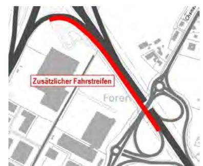
Der **Ausbau Anschluss Rotkreuz Ost (A4b)** um einen zusätzlichen Fahrstreifen in der Einfahrt ist möglich und verbessert den Abfluss Richtung Autobahn. Die Verflechtungsvorgänge werden aber nur bedingt besser, da ein zusätzlicher Fahrstreifen gequert werden muss und die Entwicklungslänge gegeben ist. Eine Projektskizze hierzu befindet sich in Anhang 13.
