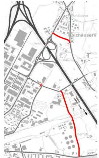
**R1+A5 (R1A5)** Die Kombination des Halbanschlusses Buonaserstrasse mit der Ostumfahrung ermöglicht eine zweite Anbindung von der Autobahn (von/nach Norden) in das Gewerbe- und Industriegebiet Rotkreuz bzw. v.a. auch in das Suurstoffi-Areal. Daraus ergibt sich eine deutliche Entlastung der Chamerstrasse und des Autobahnanschlusses Rotkreuz. Der Forren-Kreisel wird gut entlastet, einzig die Zufahrt von der Blegistrasse bleibt kritisch.
