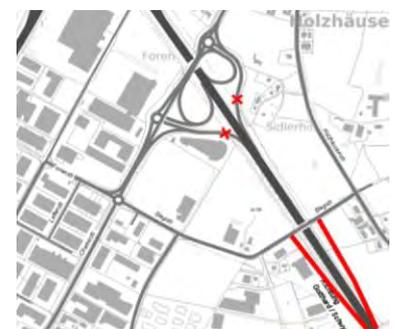
Ein **Ausbau des Anschlusses Rotkreuz West (A4a)** ist mit einem zusätzlichen Fahrstreifen möglich. Damit können die Verflechtungen, Ein- und Ausfahrten besser auf die Fahrstreifen verteilt werden und es können direkt 2 Fahrstreifen auf die Ausfahrt geführt werden. Dadurch kann die Verkehrsqualität von E-F auf B verbessert werden. Eine Projektskizze hierzu befindet sich in Anhang 12.
