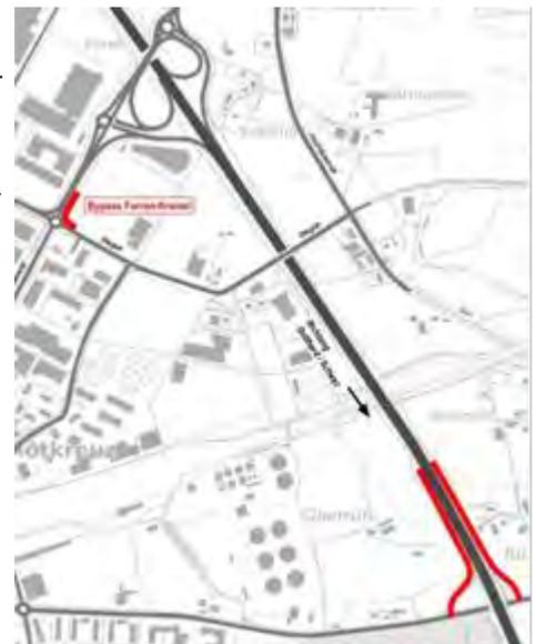
**Variante 2 (F3+R1+A5)** Ausbau Kreisell Forren mit Bypass von der Blegistrasse (kurzfristig), Halbanschluss Buonaserastrasse (mittelfristig) und Ostumfahrung Rotkreuz (langfristig); weitgehende Lösung der Verkehrsprobleme bzw. Erfüllung der Anforderungen auch mit besserer Erschliessung.
