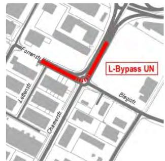
Die Leistungsfähigkeit eines Kreisels kann nicht beliebig erhöht werden und insbesondere bei starken Geradeaus- oder Linksabbiegeströmen werden entsprechende Ausbaumaßnahmen schnell kompliziert (unterirdische Bypässe respektive Überführungen). Zudem ist eine Verkehrsbeeinflussung an einem Kreisel nicht möglich. Mit einer **Lichtsignalanlage (F6)** und einer entsprechenden Vorsortierung sind höhere Gesamtknotenkapazitäten sowie eine gezielte Verkehrsbeeinflussung bzw. Verkehrssteuerung möglich.
