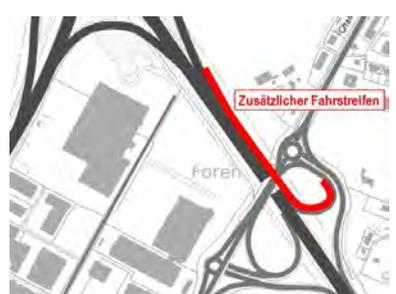
Mit einem **Halbanschluss Buonaserstrasse (A5)** von/nach Norden kann der bestehende Anschluss Rotkreuz auf den kritischen Rampen von/nach Norden um bedeutende 20%-30% entlastet werden, indem der Verkehr nach Rotkreuz aufgeteilt wird (nach Zielgebiet nördlich/südlich der Bahnlinie). Damit werden die Chamerstrasse und der Forrenkreisel um ca. 15% entlastet, womit letzterer wieder leistungsfähig betrieben werden kann.
