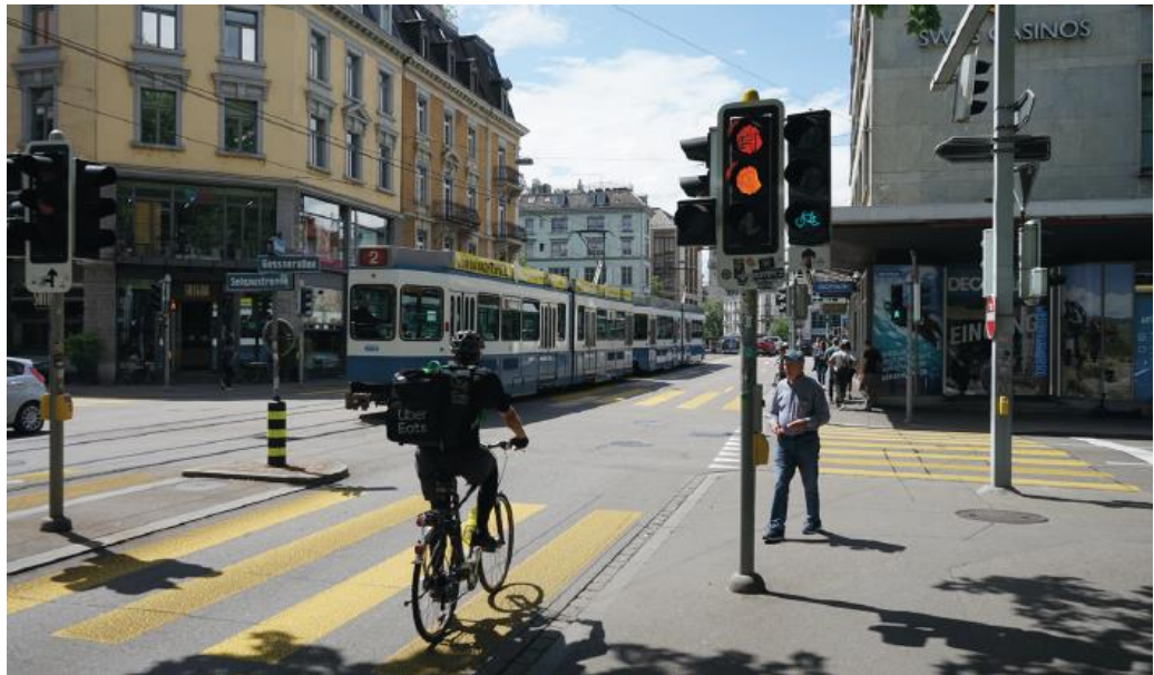
Abbildung 47: Optimierung der Velophasen durch eigenen Signalgeber
