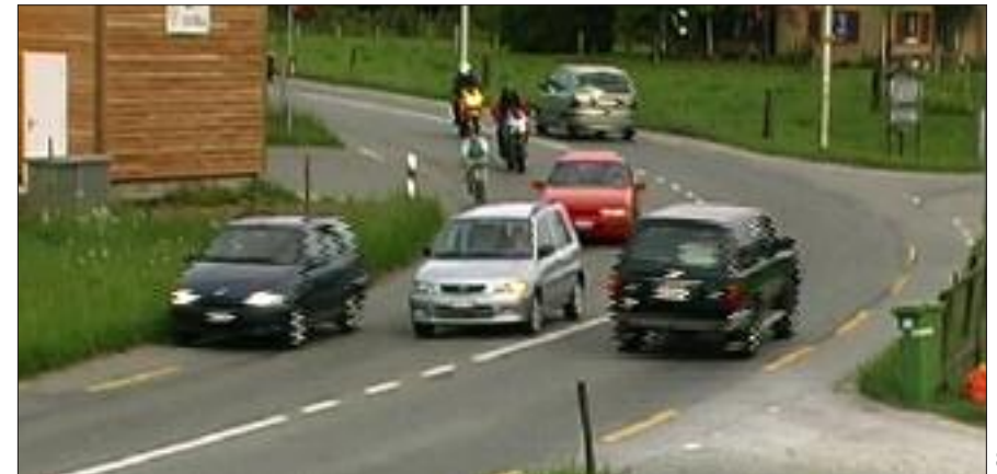
Abb. 77/78/81/82: Dank den im Bereich der Kurve genügend breiten Radstreifen können zum Abbiegen in der Strassenmitte wartende Fahrzeuge auch im Vorher-Zustand ohne Mittelzone gut rechts überholt werden. Abb. 80: FussgängerInnen dient der Radstreifen als Trottoirersatz.
