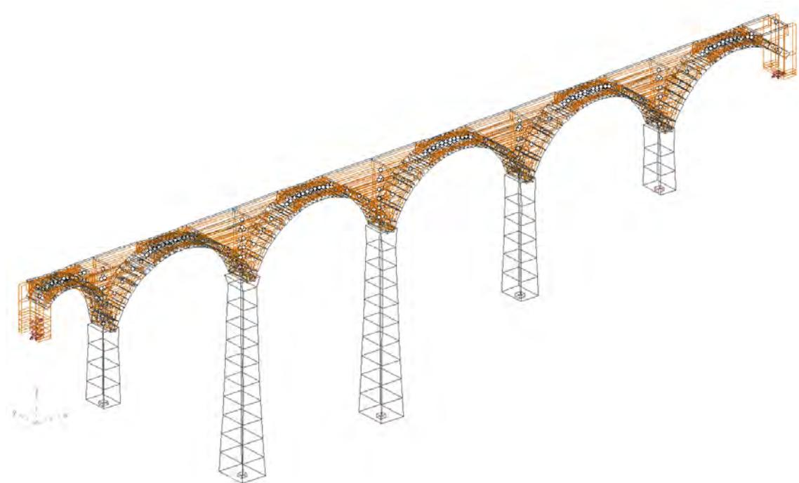
Abbildung 58: Räumliches Stabmodell für Schwingungen in Brückenquerrichtung
