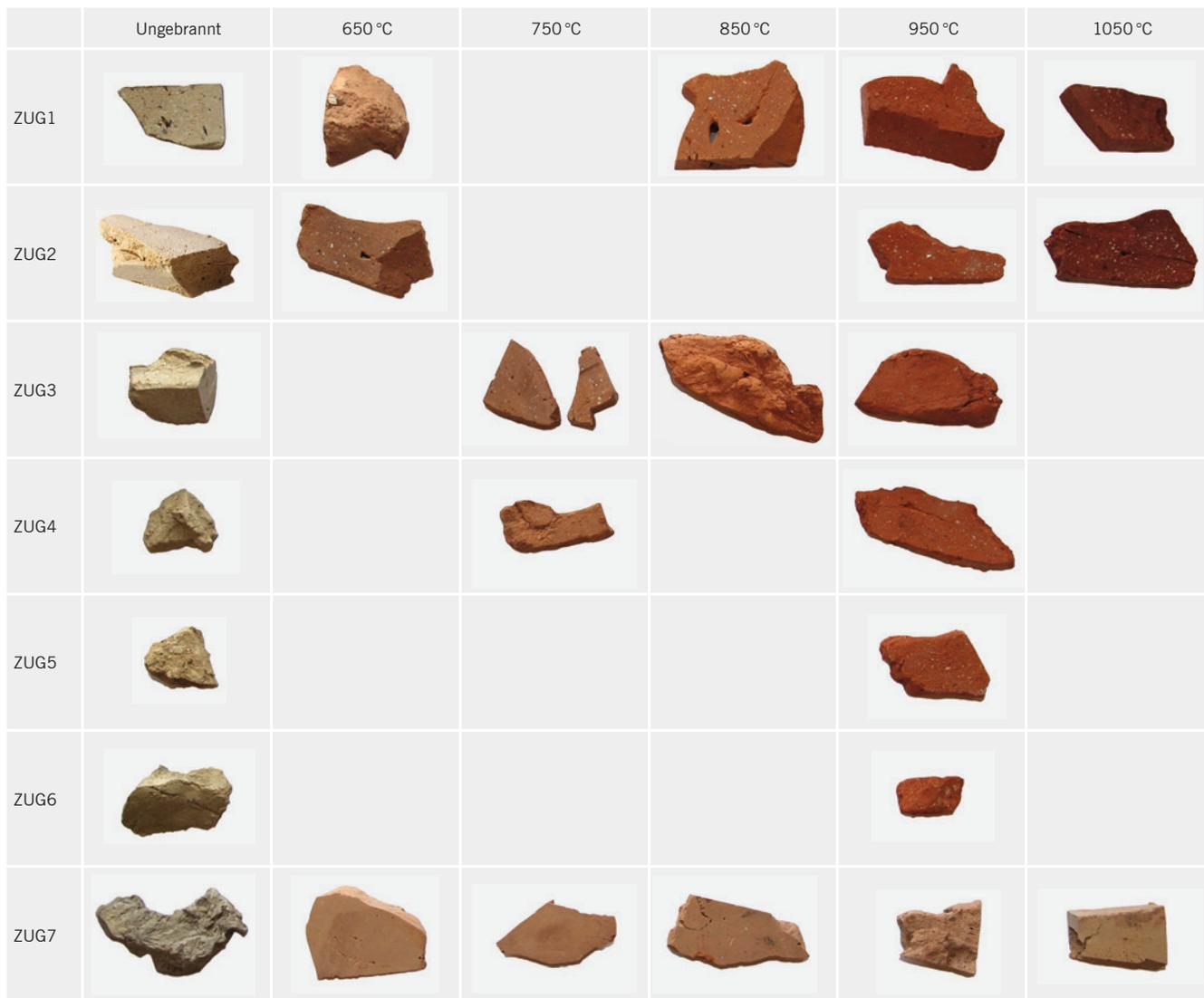
Abb. 110: Im Brennversuch gebrannte Probestücke (Grünlinge Ofenkeramik, ZUG1–ZUG6, und Rohtonbrocken, ZUG7).
