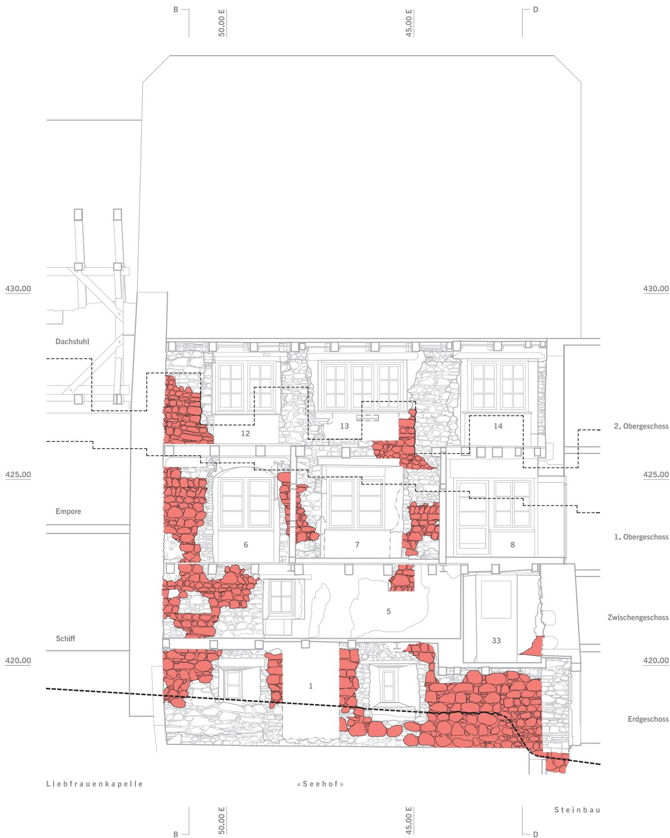
Abb. 16: Unteraltstadt 38, Ringmuer (Phase I), Schnitt C-C, Blick nach Süden, M. 1:100. Steingerechte Ansicht der Ringmuer.
