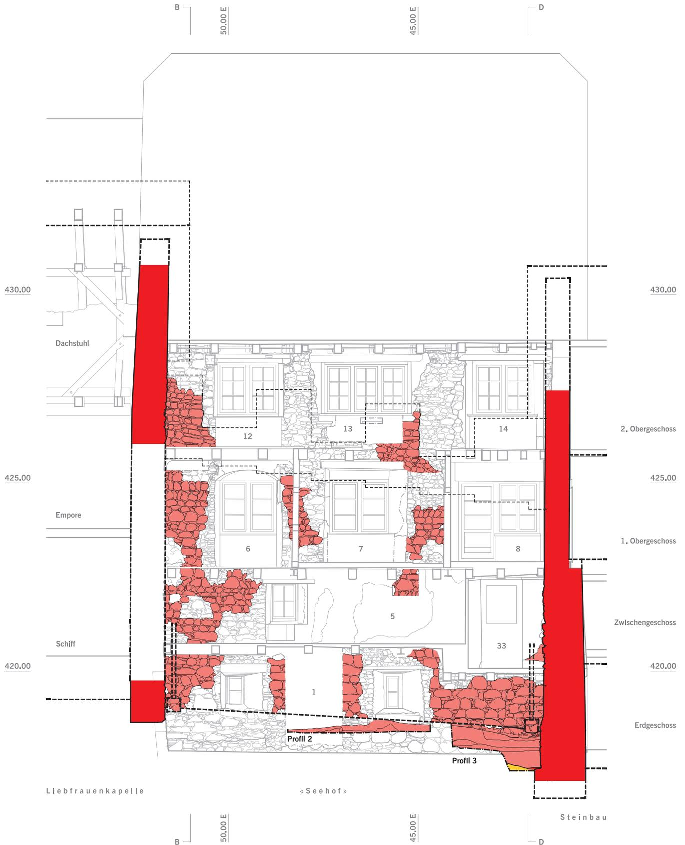
Abb. 47: Unteraltstadt 38, Holzbau 2 (Phase VI), Schnitt E–E, Blick nach Süden, M. 1:100. Schnitt Ostfassade Liebfrauenkapelle (Phase V), Schnitt rekonstruierter Holzbau 2 (Phase VI) und steingerechte Ansicht Ringmauer (Phase I), Schnitt Ostfassade Steinbau (Phase II).
