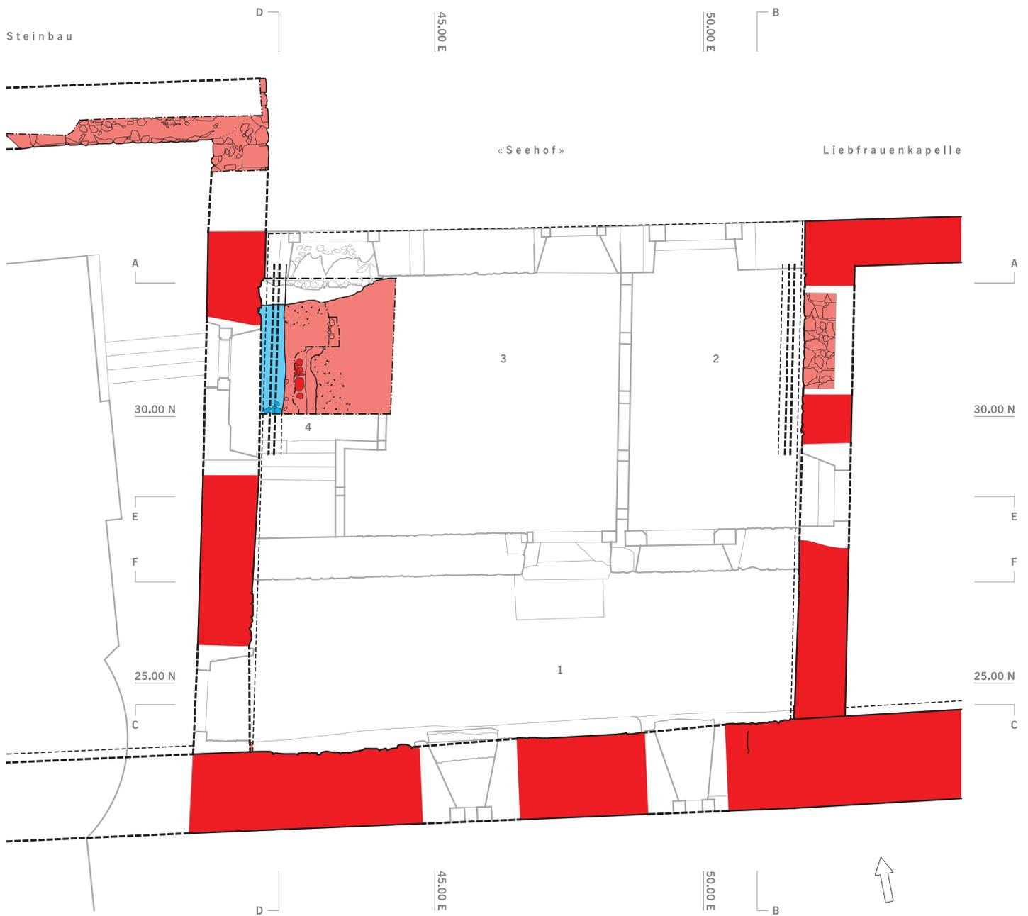
Abb. 46: Unteraltstadt 38, Holzbau 2 (Phase VI), Grundriss Erdgeschoss, M. 1:100.
