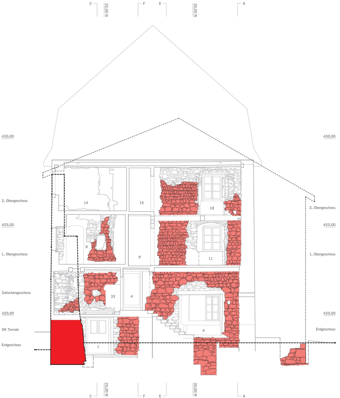
Abb. 53: Unteraltstadt 38, Aufhöhung der Ringmuer (Phase VII), Schnitt D–D, Blick nach Westen, M. 1:100. Schnitt Ringmuer (Phase I) und rekonstruierte Aufhöhung der Ringmuer (Phase VII), steingerechte Ansicht Ostfassade Steinbau (Phase II) und Rekonstruktion der Anpassung der Dachfläche (Phase VII).
