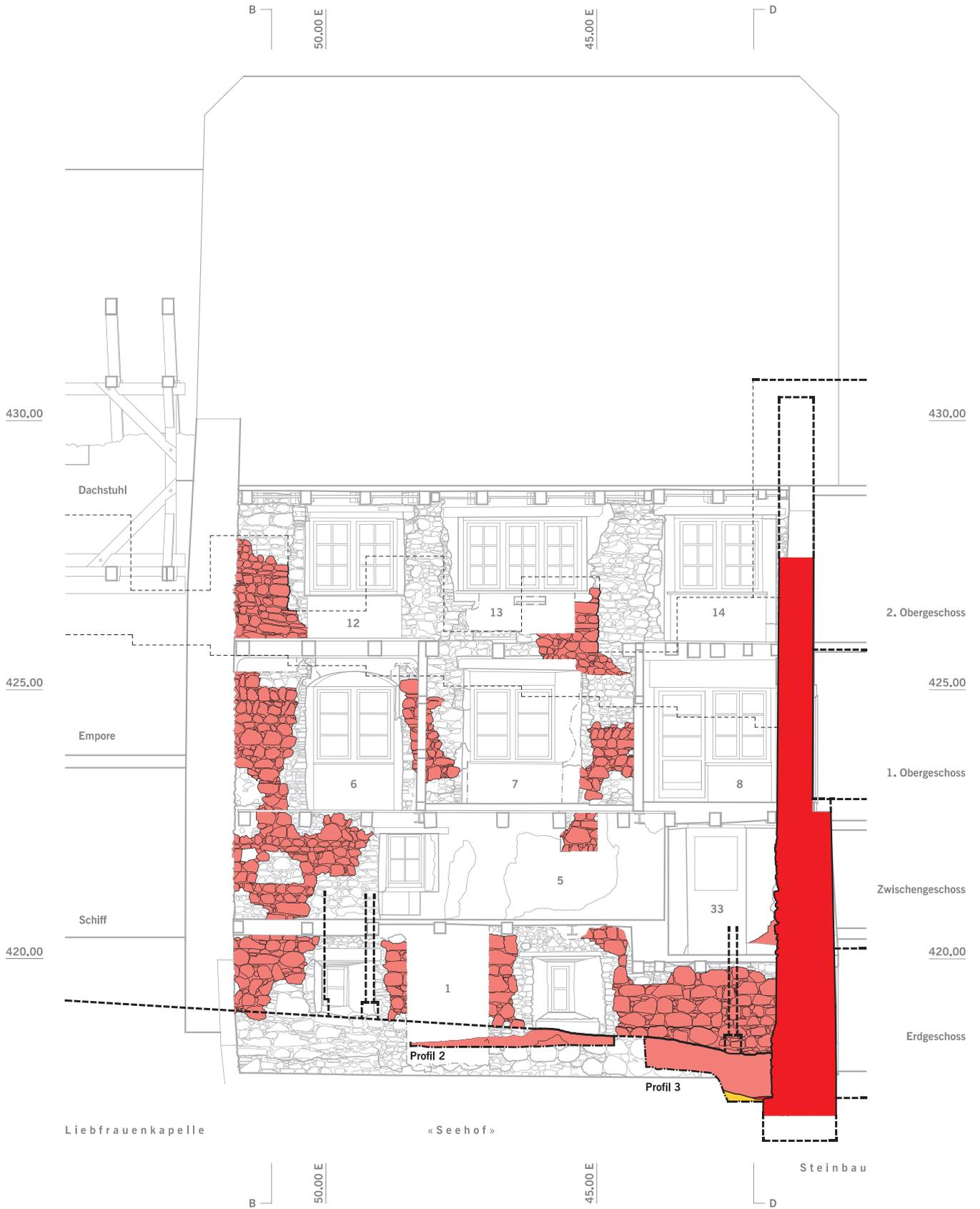
Abb. 33: Unteraltstadt 38, Holzbau 1 (Phase III), Schnitt E–E, Blick nach Süden, M. 1:100. Steingerechte Ansicht Ringmauer (Phase I), Schnitt rekonstruierter Holzbau 1 (Phase III), Schnitt Ostfassade Steinbau (Phase II).
