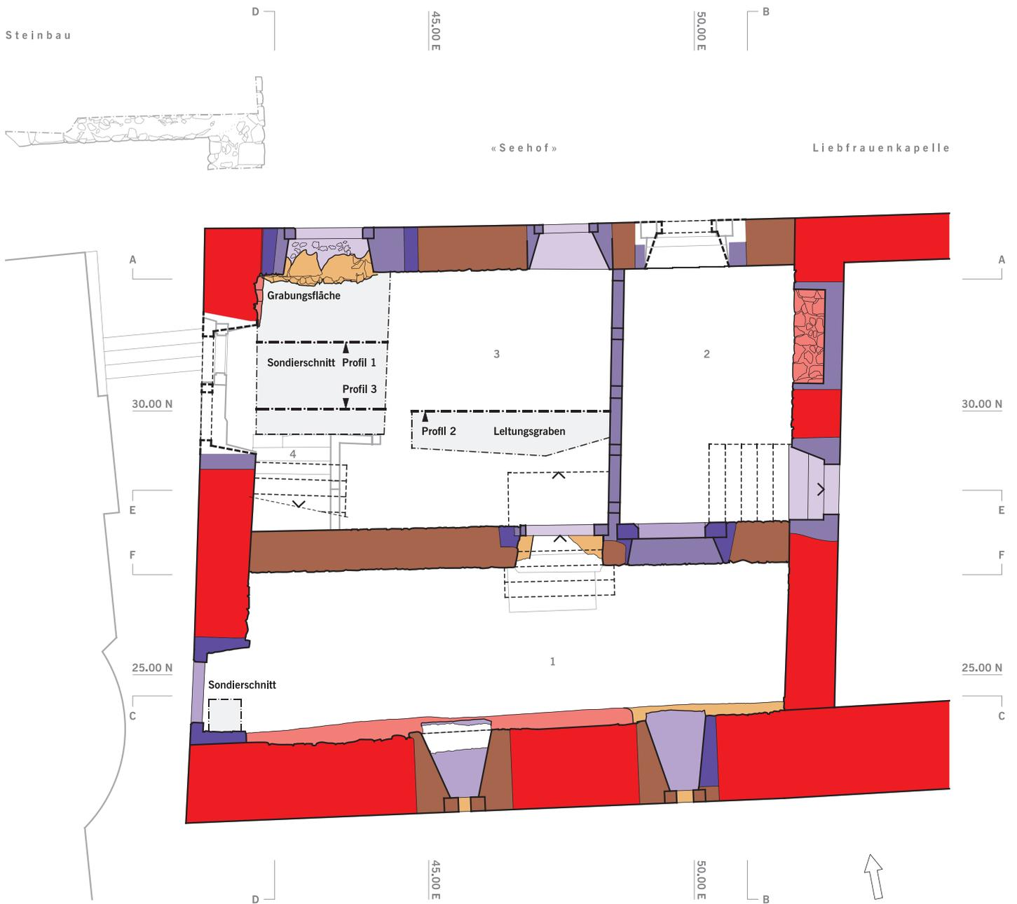
Abb. 19: Unteraltstadt 38, Grundriss Erdgeschoss, M. 1:100. Grau unterlegt sind: Grabungsfläche in Raum 4, Leitungsgraben in Raum 3 sowie Sondierschnitt in Raum 1. Die Strich-Punkt-Linien sind Grabungsgrenzen; Lage und Verlauf der Profile 1–3 sind stärker ausgezeichnet.
