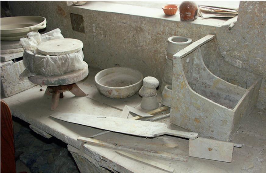
Abb. 82a: Wels A, Pfarrgasse 17, ehemalige Hafnerei Tschuden. Ununterbrochener Töpfereibetrieb zwischen 1529 und 1989. Blick auf den Arbeitstisch mit kleiner Drehscheibe, Werkzeug und Schlickkasten.
