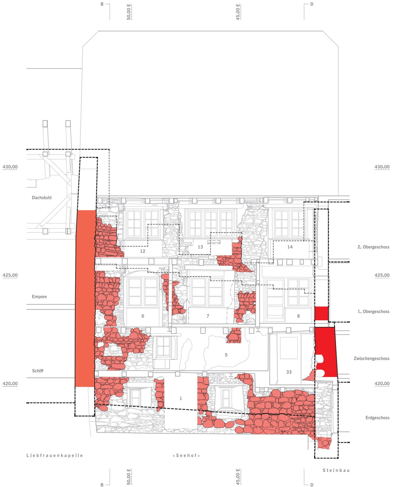
Abb. 45: Unteraltstadt 38, Liebfrauenkapelle (Phase V), Schnitt C–C, Blick nach Süden, M. 1:100. Schnitt Ostfassade Steinbau (Phase II), steingerechte Ansicht Ringmauer (Phase I), Schnitt Westfassade Liebfrauenkapelle (Phase V).
