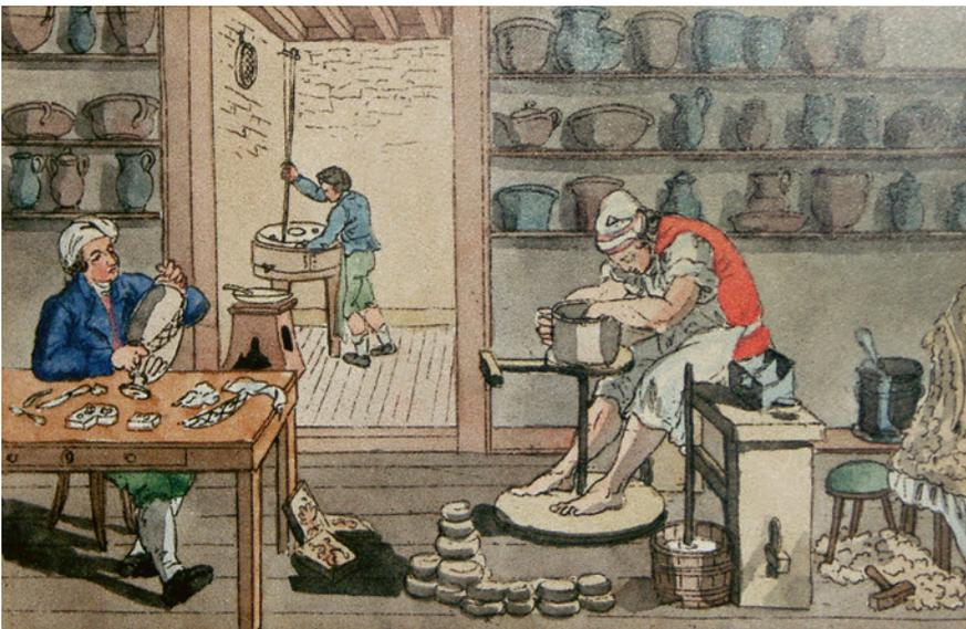
Abb. 82b: Werkstattbild einer Töpferei des 18. Jahrhunderts. Deutlich erkennbar ist auf der Bank des sitzenden Drehers der zweiteilige Schlickkasten.
