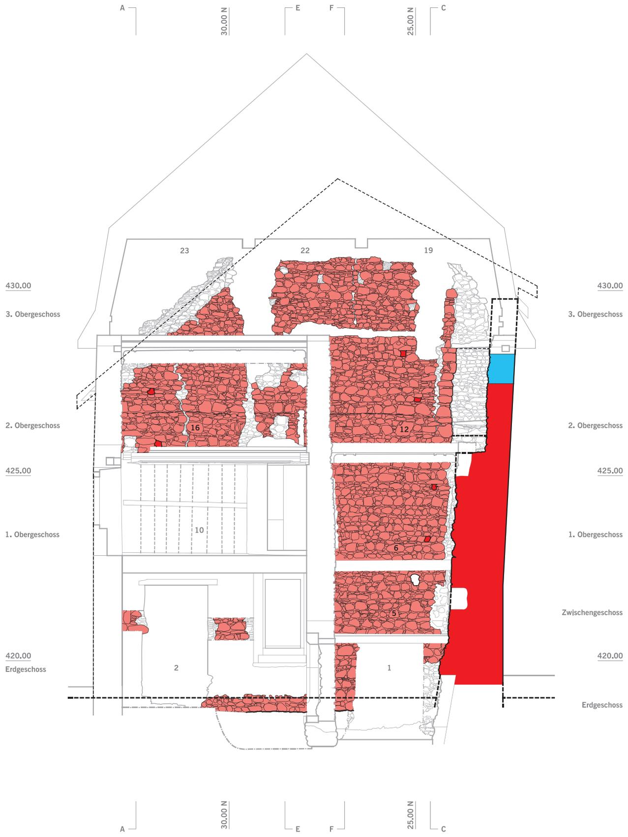
Abb. 54: Unteraltstadt 38, Aufhöhung der Ringmauer (Phase VII), Schnitt B-B, Blick nach Osten, M. 1:100. Steingerechte Ansicht Ostfassade Steinbau (Phase II) und Rekonstruktion der Anpassung der Dachfläche (Phase VII), Schnitt Ringmauer (Phase I) und Aufhöhung der Ringmauer (Phase VII).
