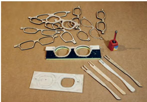
Mittels präzisen Frässhablonen wird die Form kopiert.
