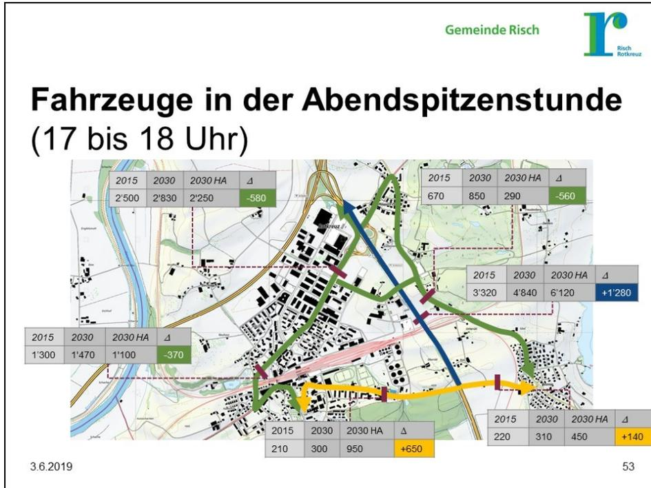
Auf diese Folie sehen Sie an sechs Punkten die Veränderung der Verkehrsentwicklung bei Realisierung des Halbanschlusses Rotkreuz Süd: Die grün eingefärbten Strassenabschnitte erfahren eine Entlastung, der orange Abschnitt (Buonaserstrasse) erfährt zusammen mit dem blauen Abschnitt auf der Autobahn eine Belastung. Zwei Lesebeispiele:
