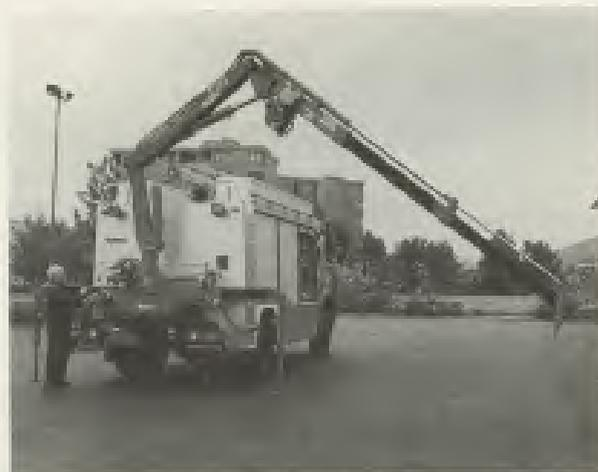
*Gleiches Fahrzeug mit Ladekran und integr. Seilwinde*
