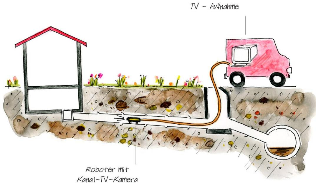
Sind die Entwässerungsanlagen Ihrer Liegenschaft seit längerer Zeit in Betrieb, ist es sinnvoll, den Zustand der Anlagen - nach vorgängiger Reinigung - durch erfahrene Spezialfirmen für Kanalfernsehen begutachten zu lassen. Die Zustandsaufnahmen der Leitungen im Untergrund sollten regelmässig (**mind. alle 10 Jahre**) erfolgen. Dieses Vorgehen verschont Sie vor unangenehmen Überraschungen.
