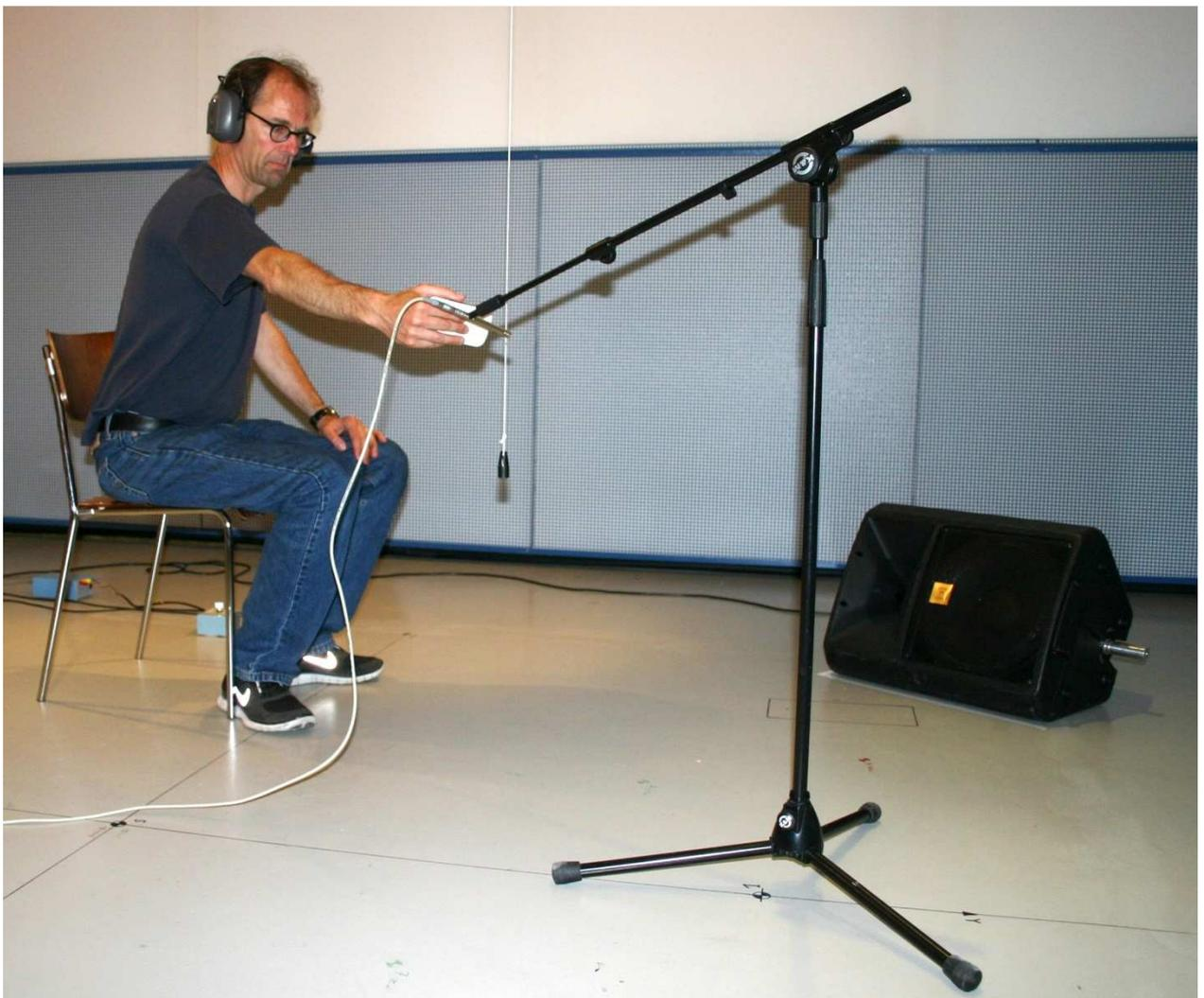
Abbildung 1: Messkonfiguration im reflexionsarmen Raum mit hartem Boden.
