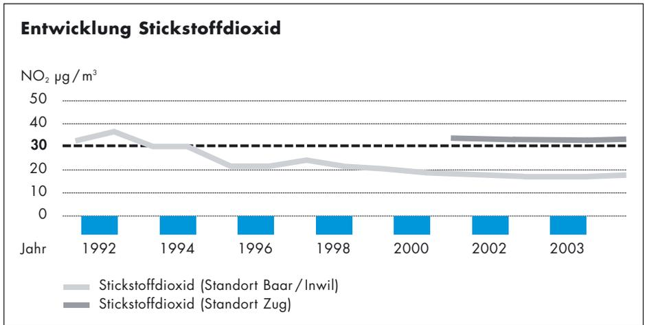
Verlauf Stickstoffdioxid-Belastung seit 1992. Der NO<sub>2</sub>-Grenzwert liegt bei 30 µg/m<sup>3</sup>.
